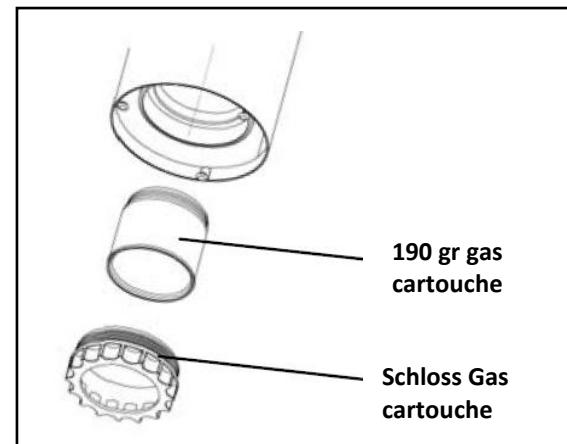
Bei Gasgeruch oder wenn Sie der Ansicht sind, dass die Gaskartusche leckt, nachdem Sie sie angeschlossen haben, bringen Sie das Gerät an einen gut belüfteten Ort und halten Sie es von Zündquellen fern. Wenn Sie prüfen möchten, ob Ihr Gerät leckt, sollten Sie dies im Freien tun. Versuchen Sie nicht, Lecks mithilfe einer Flamme zu finden. Verwenden Sie Seifenlauge.
