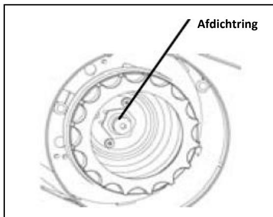
Gebruik de gaslantaarn niet als de afdichtring beschadigd is of ontbreekt!
